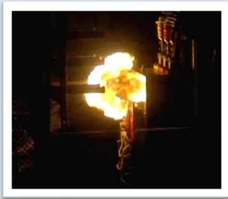
Arc Flash Test
